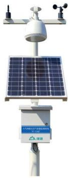
**简介：**环境空气自动监测系统用于连续监测空气 CO NOX SO2 O3 PM2.5 PM10 大气压 温度 湿度 风速 风向等参数。传感器是选用进口高精度电化学传感器，采用泵吸式采样方式监测，内置除水除尘过滤器，可以很好的保护传感器不受侵害。是各种高危场所挥发性有机物的理想安全监测设备，可以连续监测其浓度。
