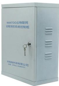
**简介：**ManToo 云物联网远程测控系统控制柜采集各热力点的流量计（压力、温度、流量）数据以及开关阀的信息，通过 4G 网络直接上传漫途云实时查看，一旦数据越线、现场设备故障，远程控制端即出现报警信息，同时对泵、阀门控制启动。
