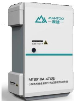
**简介：**MTB910A-4ZX 是一款广泛应用于小型水库安全监测分布式系统节点终端。内部集成了 lora 无线传输和多通道振弦采集。用于实时监测振弦、温度传感信号，同时利用 LoRa 无线通信技术与 Lora 主站进行远距离数据传输，实现数据有线到无线的传输。
