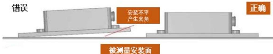
2) 传感器轴线与被测量轴线必须平行, 两轴线尽可能不要产生夹角。
